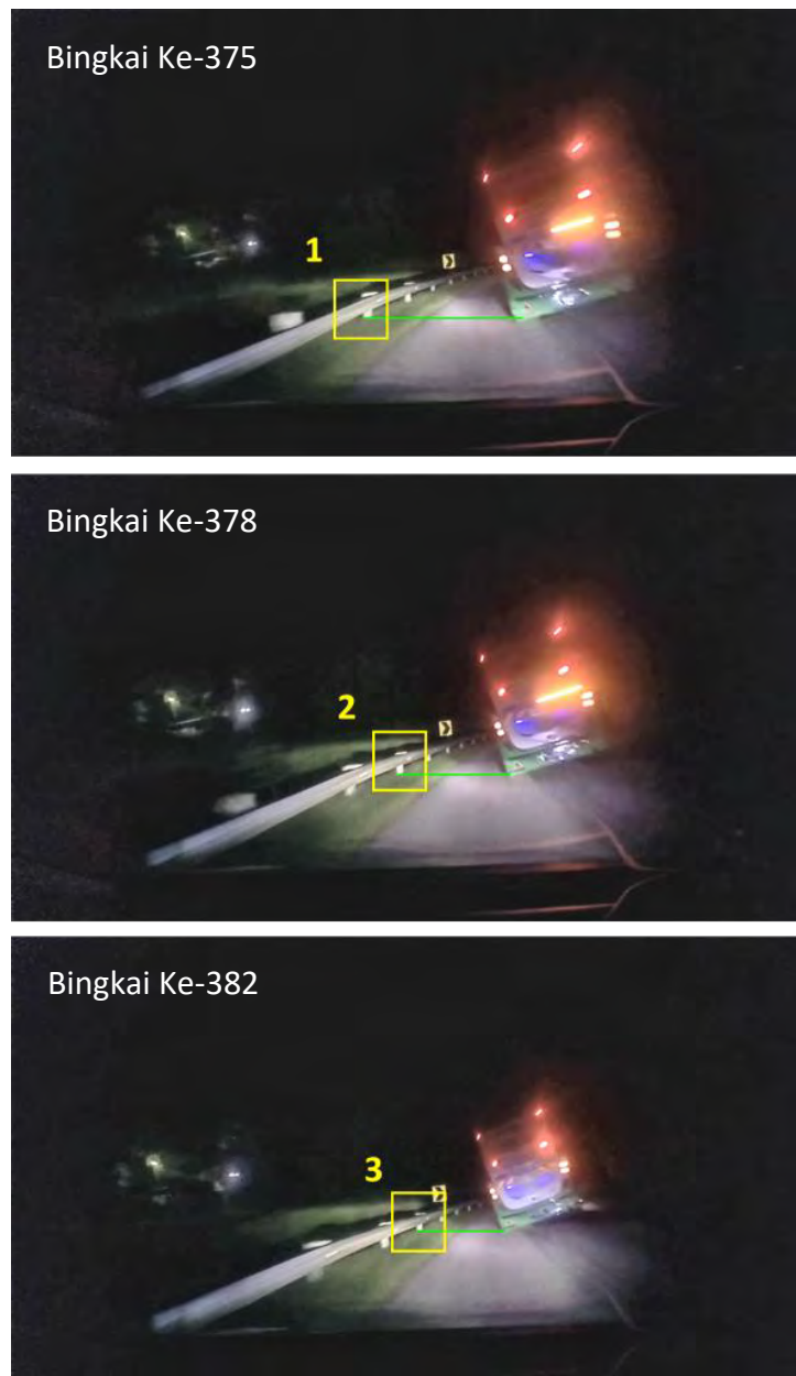
Gambar Rajah 19. Kedudukan Bas Relatif Kepada Kedudukan Tiang Penghadang Jalan Pada Bingkai Video Ke-375, 378 Dan 382.
