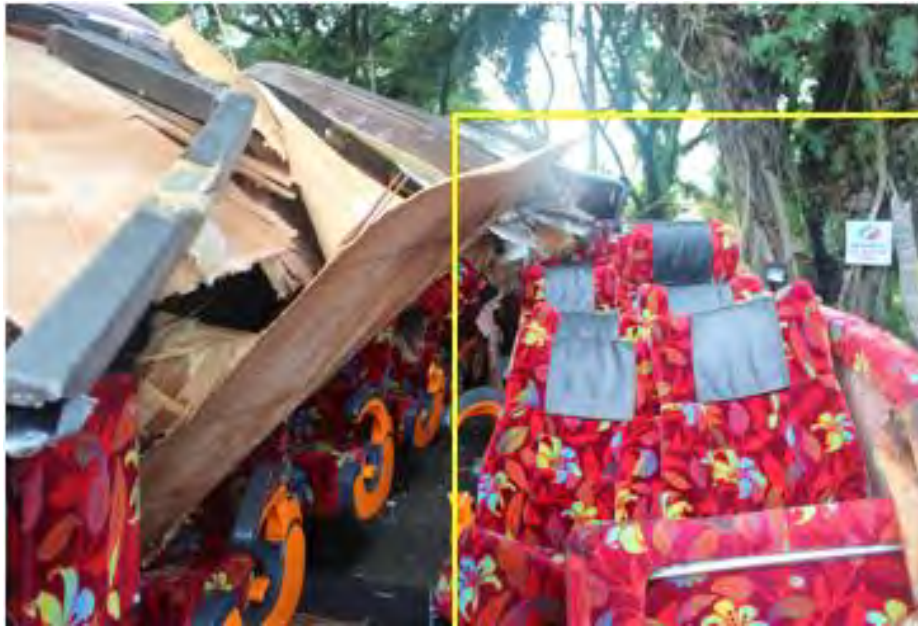
Rajah 14: Kesan Daya pada Kerusi Tempat Duduk Bahagian Kiri Bas
