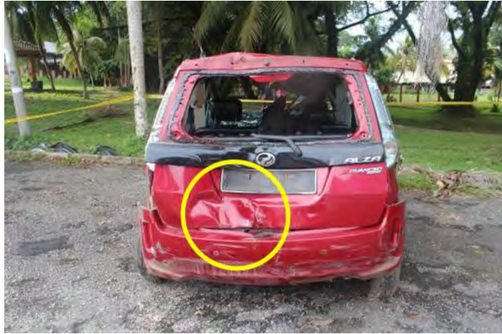
Gambar Rajah 27. Kerosakan Bahagian Bonet Belakang Perodua Alza yang Disebabkan oleh Impak daripada Bas
