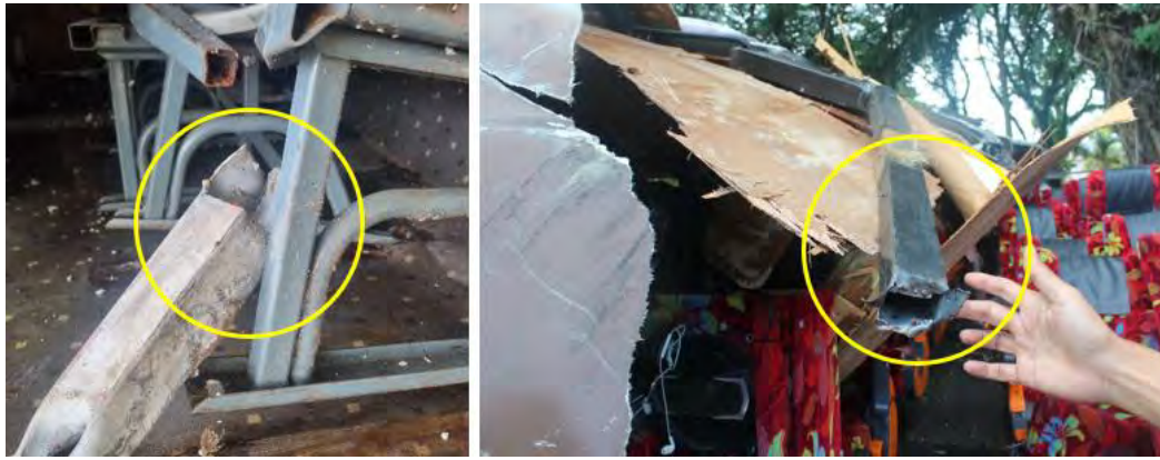
Gambar Rajah 23. Kesan Kegagalan Struktur Bas Disebabkan Tembusan Penghadang Jalan
